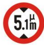
P-22 Απαγορεύεται η είσοδος σε οχήματα συνολικού ύψους που υπερβαίνει τα... (π.χ. 5,1) μέτρα.
